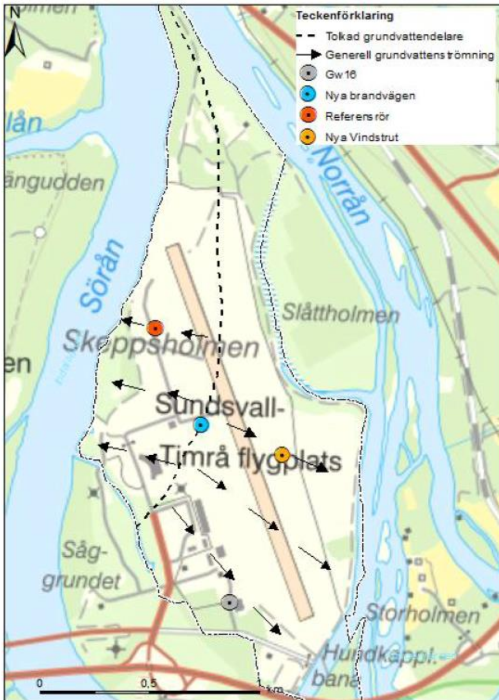
Figur 3. Generell grundvattenströmning vid normaltillstånd (Sweco, 2019).
