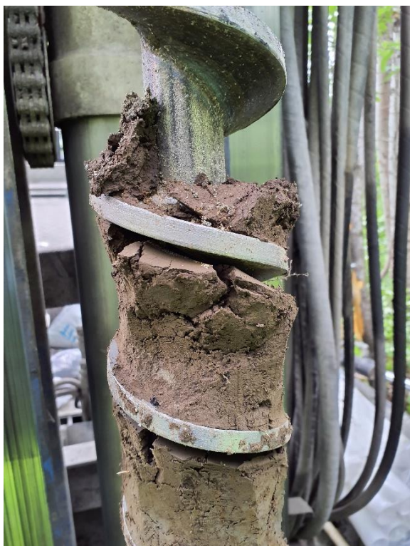
Bild 3. Provpunkt 22W11GV_1 (0-0,15m). Jordprov där PID ger utslag på 350ppm. Analysresultat visar inte på någon förorening.
