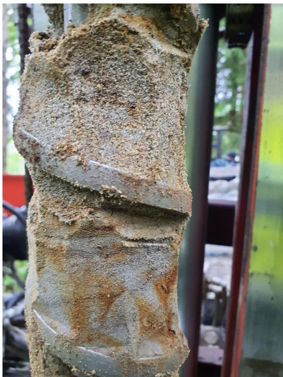
Bild 4. Provpunkt 22W16GV_2 (0,1-0,35m). Sand med inslag av rostfärg.
