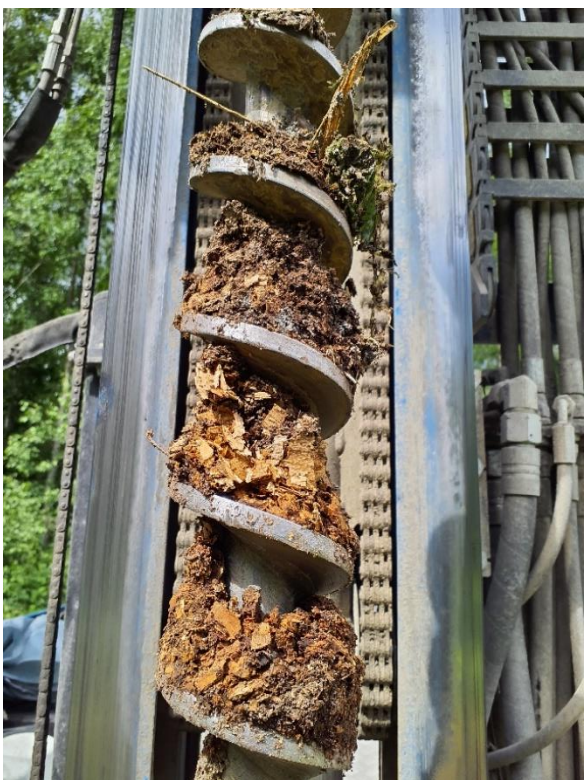
Bild 6a. Provpunkt 22W30GV_1 (0-0,35m). Träflis, ovanpå en av de förmodade deponierna/upplagsplatserna.
