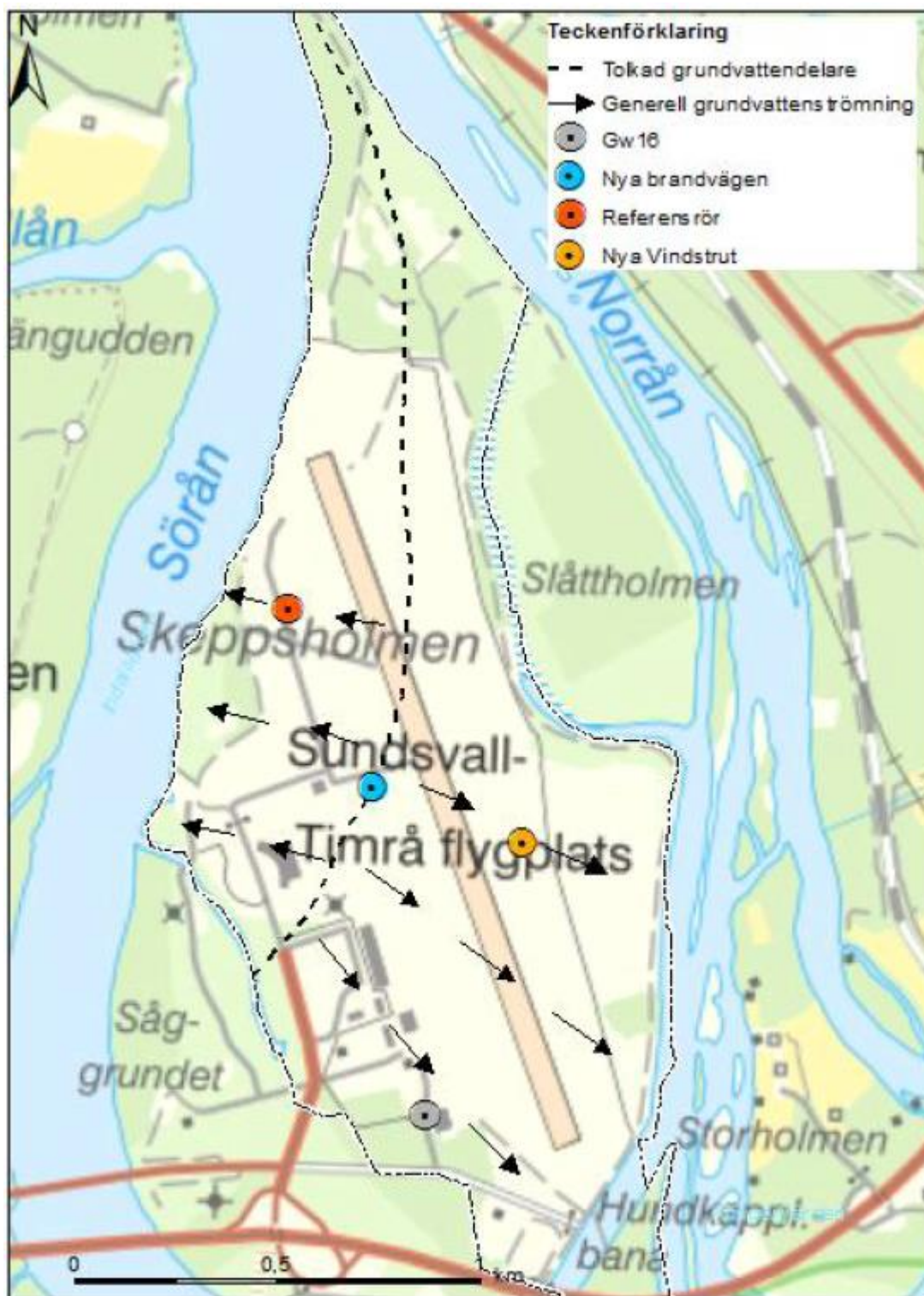
Figur 5. Generell grundvattenströmning vid normaltillstånd (Sweco, 2019).
