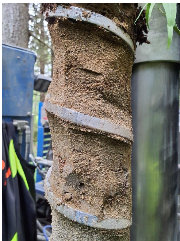
Bild 2. Provpunkt 22W10GV_2 (0,2-0,35m). Jordprov där PID ger utslag på 8,1ppm. Analysresultat visar inte på någon förorening.
