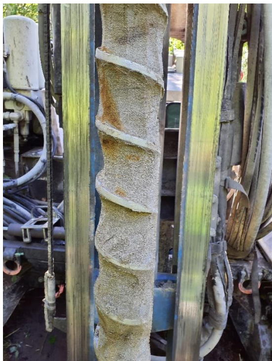
Bild 7. Provpunkt 22W35GV_3 (0,5-1m). Jord i denna punkt ligger <MRR enligt Naturvårdsverket (2009). I grundvatten påträffas Benso(a)pyren i mycket höga halter enligt SGU:s Bedömningsgrunder för grundvatten (2013). Summa PAH-H i grundvatten överstiger dricksvattenskriteriet enligt SPI (2011).
