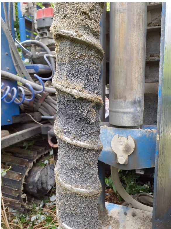
Bild 5. Provpunkt 22W21GV_5 (1,6-2m). Övergång från ljusare beige sand till grå sand under grundvattenyta.
